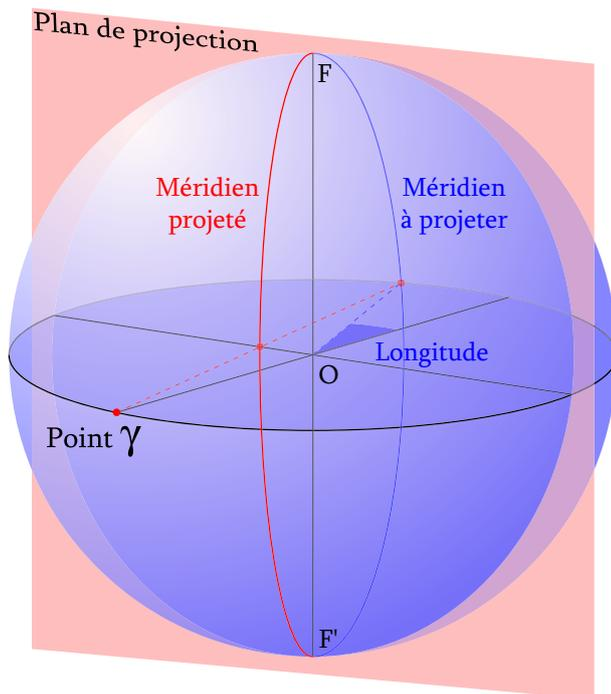
Principe de tracé des parallèles.
